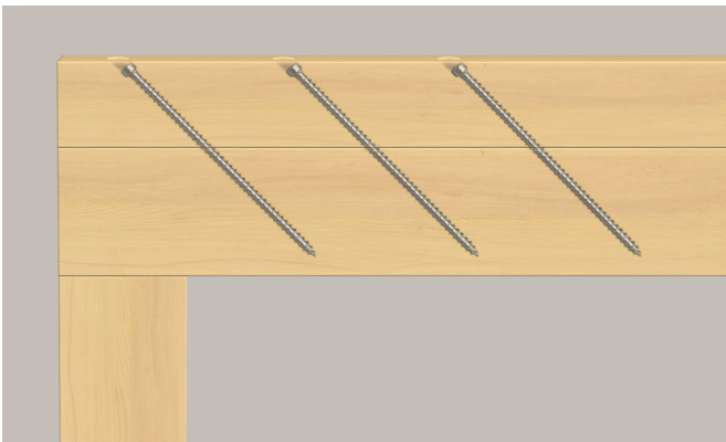
Balkenaufdopplung (nachgiebig verbundener Biegeträger)
