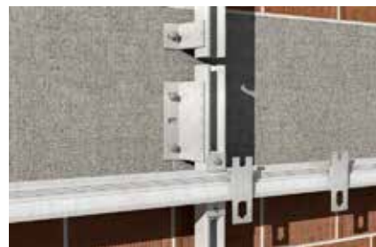
Dettaglio: fissaggio profilo VP alla staffa
