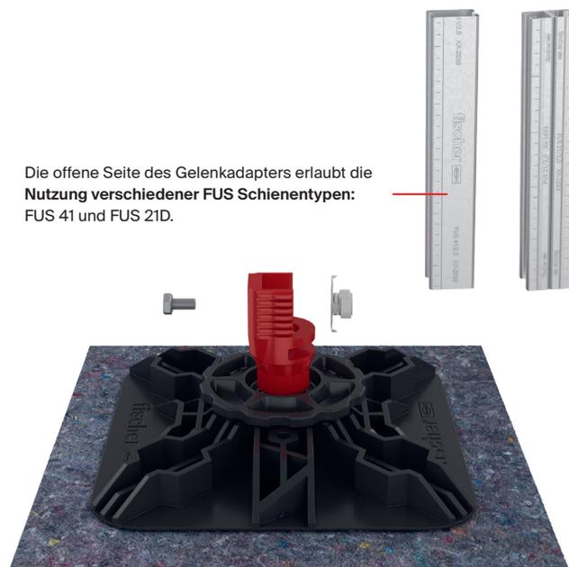
Der fischer Flachdachfuß mit Gelenkadapter FFRBH ermöglicht die passgenaue Befestigung von vertikalen FUS Montageschienen. Damit gelingt eine sichere Konstruktion zum Aufbau von verschiedenen Aggregaten, Gehwegen und Leitungen.
