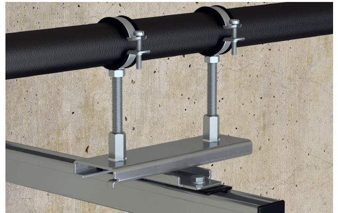
Axial-lateral Gleiter mit FCSM M12 in FUS-Montageschiene
