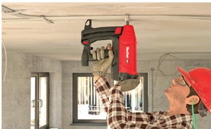
Das FGC 100 eignet sich aufgrund seiner optimalen Balance perfekt für Befestigungen an Decken
