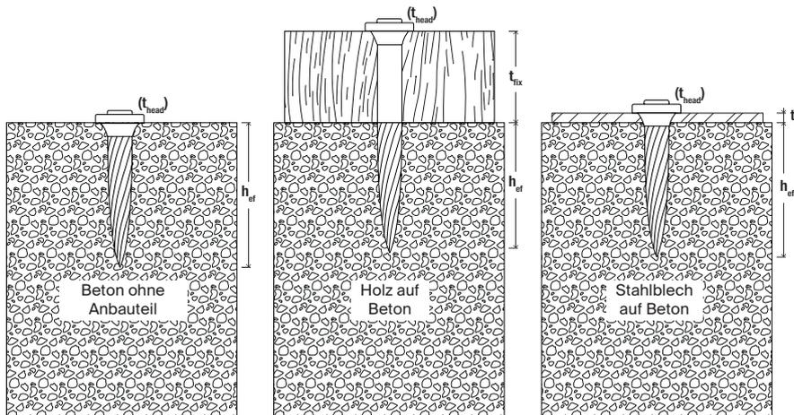
Die maximale Standard-Stahlblechdicke, die auf Beton befestigt werden kann, beträgt 2,5 mm.
