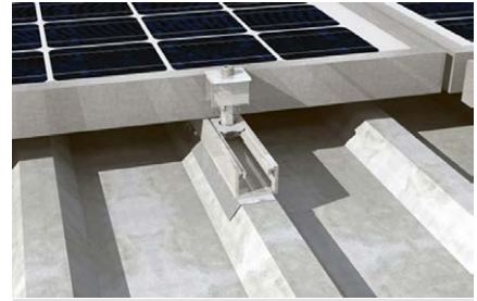
Dettaglio: Fissaggio profilo Solar 40/30
