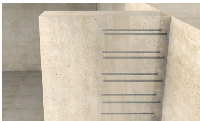
Connessione di pareti verticali
