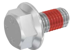
fischer Sperrzahn-schraube SKSK M8x16 A4 mit Klemmbeschichtung
