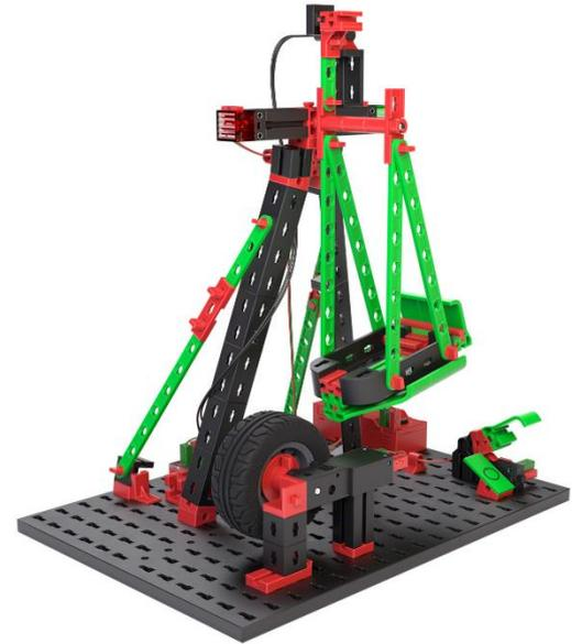
Al armar el modelo presta atención a que el barco se apoye justo sobre el aro. Gira el columpio manualmente y con la prueba de interfaz asegúrate de que el contacto reed se active cuando el imán en el barco oscilante pase por el contacto reed.
