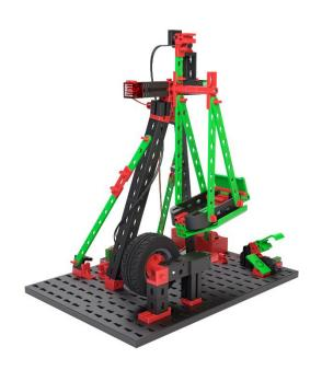
Cuando construyas el modelo, asegúrate de que la nave sólo descansa sobre el neumático. A continuación, gira el columpio con la mano y utiliza la prueba de interfaz para asegurarte de que el contacto reed se dispara cuando el imán del columpio de la nave pasa por el contacto reed.
