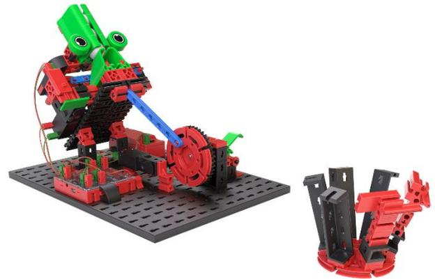
**Die verwendete Batterie, sollte eine Spannung > 8,5V betragen, damit der Wurfmechanismus zuverlässig funktioniert.**
