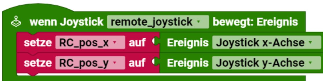
Bei dem Joystick ändern sich die Y-Werte, indem er nach oben oder nach unten gezogen wird. Die X-Werte ändern sich, wenn er nach links- oder rechts gezogen wird.
