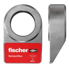
Die fischer SensorDisc ist eine Unterlegscheibe mit integrierter Mess- und Übertragungstechnik, mit der das momentan wirkende Kraftniveau einer damit ausgestatteten Schraubverbindung relativ zur Montagevorspannkraft erfasst werden kann. Der Auslesevorgang findet drahtlos auf Berührungsdistanz vermittels NFC-Übertragung an ein Auslesegerät (z. B. Smartphone) statt, die Daten werden cloudbasiert archiviert und zur Verfügung gestellt.
