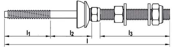
Vite doppia filettatura con guarnizione in EPDM STSI
