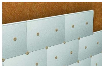
Fissaggio di cappotto in EPS su pannelli truciolari/MDF/OSB
