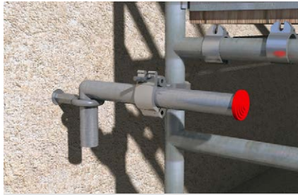
Fissaggio al ponteggio
