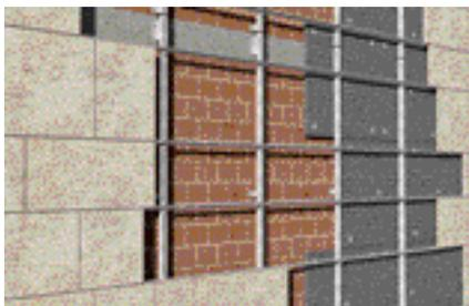
Sottostruttura montanti e traversi
