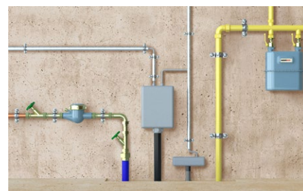
Fissaggio delle condotte.
