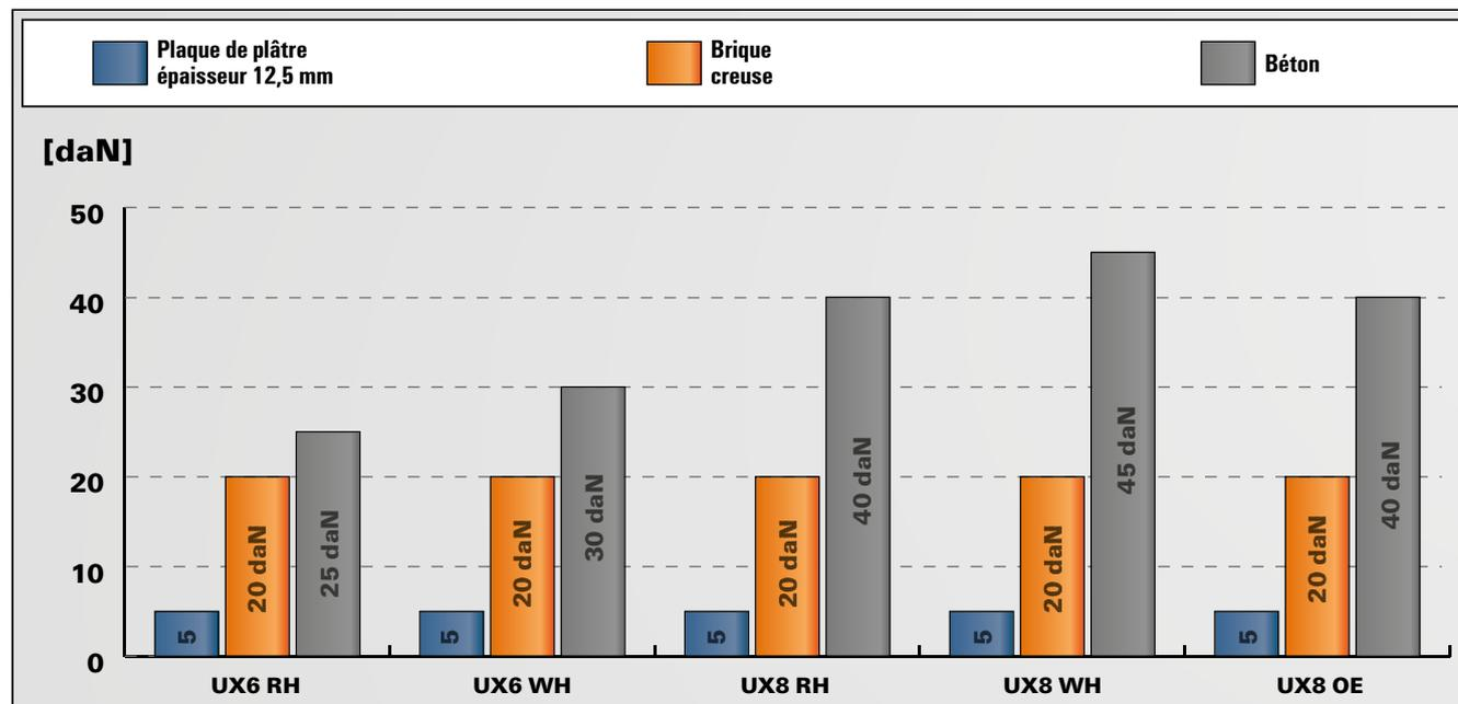
Pour les caractéristiques exactes de résistance et de pose, il convient de se référer à la fiche technique du produit. Les charges indiquées tiennent compte de coefficients de sécurité.
