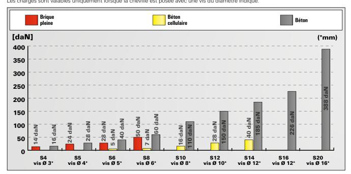
Pour les caractéristiques exactes de résistance et de pose, il convient de se référer à la fiche technique du produit. Les charges indiquées tiennent compte de coefficients de sécurité.
