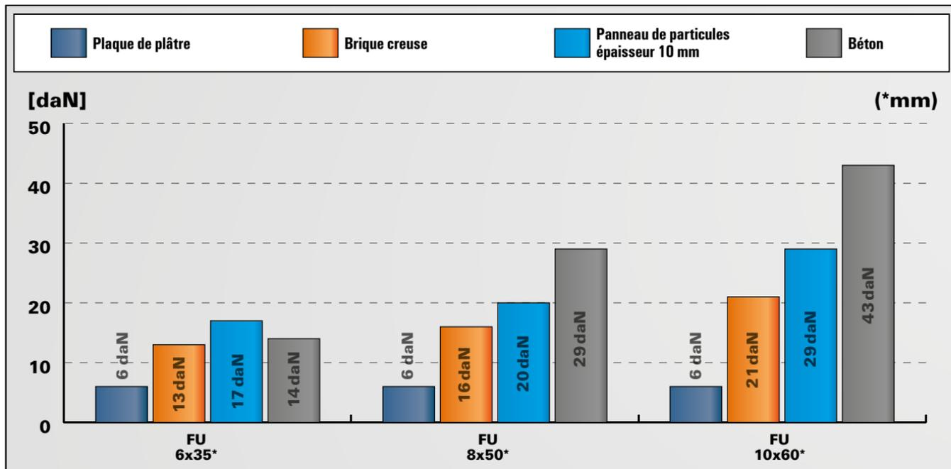
Les charges sont valables uniquement lorsque la cheville est posée avec une vis à panneaux au diamètre indiqué. Pour les caractéristiques exactes de résistance et de pose, il convient de se référer à la fiche technique du produit. Les charges indiquées tiennent compte de coefficients de sécurité.
