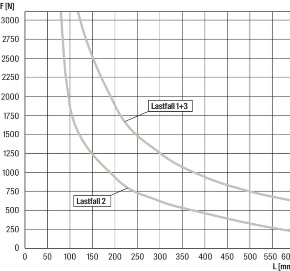
Bei den Belastungskurven wird die zulässige Stahlspannung  $\delta_{zul} = 188 \text{ N/mm}^2$  (aus erhöhter Streckgrenze durch Umformung) sowie die maximale Durchbiegung  $L/150$  nicht überschritten. Tragfähigkeitswerte bezogen auf die Konsolen. Die Befestigungen zum Untergrund wie Dübel, Schrauben müssen den Belastungen entsprechend ausgelegt werden.
