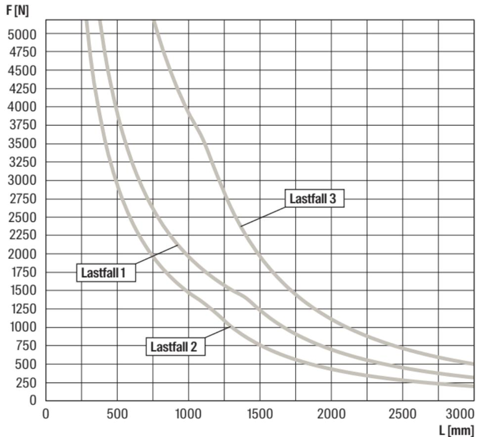
Bei den Belastungskurven wird die zulässige Stahlspannung  $\delta_{zul} = 188 \text{ N/mm}$  sowie die maximale Durchbiegung  $L/200$  nicht überschritten. Die Befestigungen Dübel, Schrauben müssen den Belastungen entsprechend ausgelegt werden. Die erhöhte Streckgrenze ist durch Berechnung nach DIN EN 1993-1-3:2010-12, Abs. 3.2.2 erfolgt.
