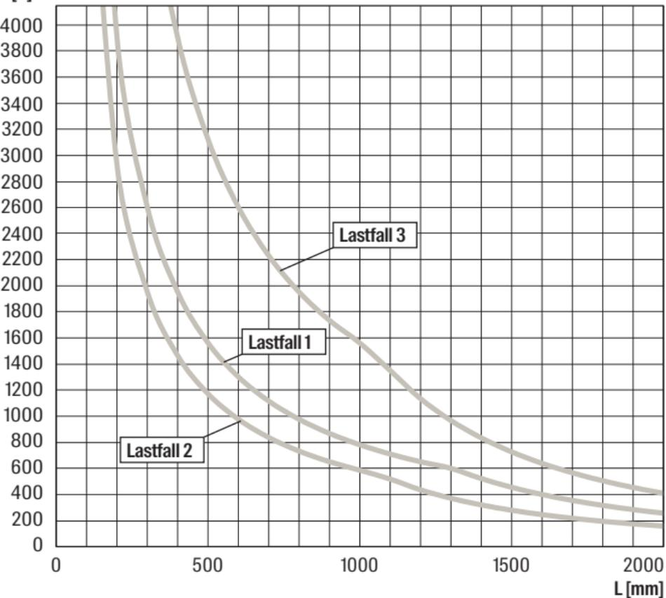
Bei den Belastungskurven wird die zulässige Stahlspannung  $\delta_{zul} = 188 \text{ N/mm}^2$  sowie die maximale Durchbiegung  $L/200$  nicht überschritten. Die Befestigungen Dübel, Schrauben müssen den Belastungen entsprechend ausgelegt werden. Die erhöhte Streckgrenze ist durch Berechnung nach DIN EN 1993-1-3:2010-12, Abs. 3.2.2 erfolgt.
