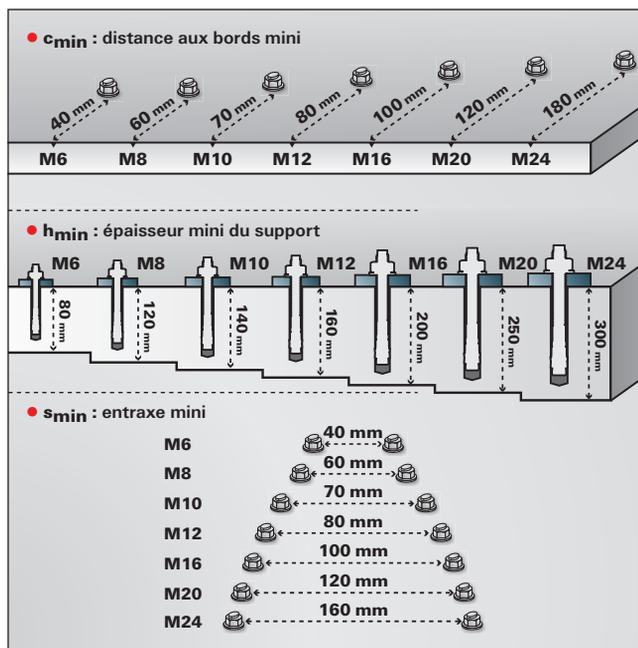
Pour les caractéristiques exactes de résistance et de pose, il convient de respecter toutes les exigences mentionnées dans l'Agrément Technique Européen ETA-07/0025 (FHII) ainsi que sur la notice de pose.
