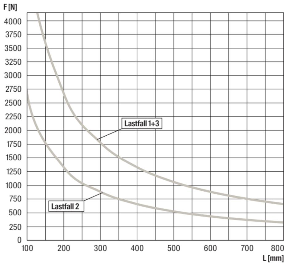
Bei den Belastungskurven wird die zulässige Stahlspannung  $\delta_{zul} = 160$  N/mm sowie die maximale Durchbiegung  $L/150$  nicht überschritten. Tragfähigkeitswerte bezogen auf die Konsolen unter Berücksichtigung der Tragfähigkeit der Grundplatte. Die Befestigungen Dübel, Schrauben müssen den Belastungen entsprechend ausgelegt werden. Die Belastungskurven sind gültig für alle Materialstärken der FCA Konsolen.
