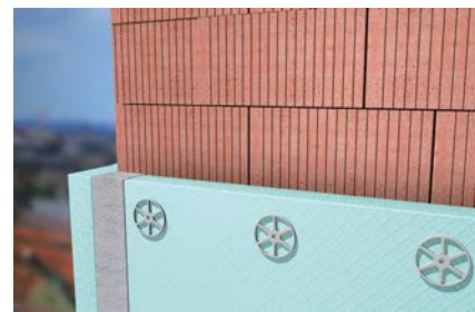
Dettaglio: incollaggio di pannelli isolanti
