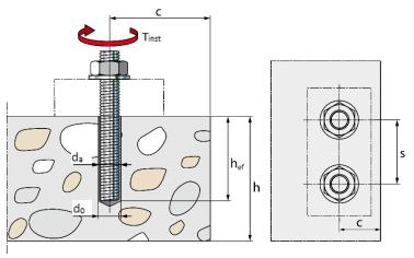
FIGURE 1—INSTALLATION PARAMETERS
