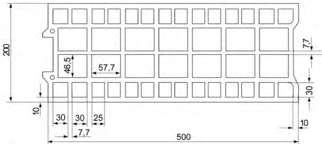
Tabelle C40: Montagekennwerte für Ankerstangen mit Siebhülse
