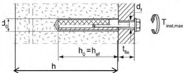
**Ankerstangen und Innengewindeanker UPM-I ohne Siebhülsen UPM SH K; Montage in Porenbeton (Montage mit Konusbohrer PBB)**
