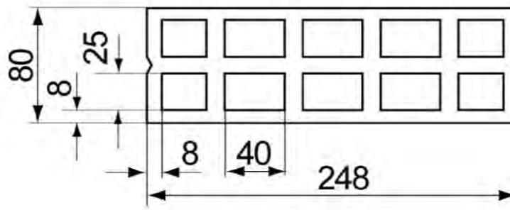
Tabelle C68: Montagekennwerte für Ankerstangen mit Siebhülse
