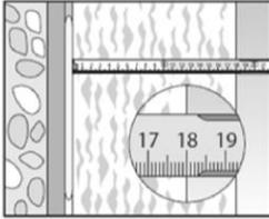
1. Ermitteln der Dämmstoffdicke  $h_D$
