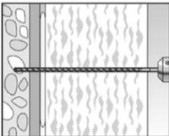
3. Bohrloch erstellen. Die gesamte Bohrlochtiefe muss entsprechend des termoz SV II ecotwist
