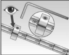
2. Dämmstoffdicke  $h_D$  in mm an Setzwerkzeug mit Stelling (Setztiefenmarkierung) einstellen. Die Zahl muss sichtbar sein. Optional zur Vereinfachung der Montage kann zusätzlich eine dünne Kunststoffscheibe (max. 1 mm) als Anschlag mit aufgeschoben werden.
