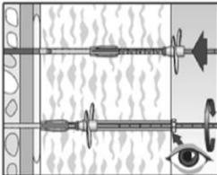
4. Dübel mit Schraubteller an Dämmplattenoberfläche fest andrücken und den Einschraubvorgang beginnen. Den Setzvorgang beenden, wenn der Stelling bündig mit der Dämmplattenoberfläche ist.
