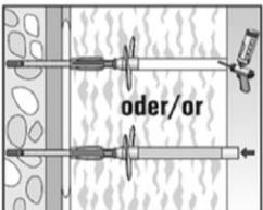
5. Der Einführkanal des Dübels im Dämmstoff, ist mit geeignetem Schaum auszuspritzen (s. abgebildete Darstellung Anhang A1) oder mit einem Dämmstoffstopfen zu verschließen.
