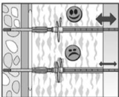
5. Nach Erreichen der Setztiefe über das Setzwerkzeug kräftig gegen den gesetzten Dübel drücken. Falls sich der Dübel nicht axial bewegt, das Montagetool aus dem Dämmstoff ziehen. Der Setzvorgang ist beendet. Falls sich der Dübel axial bewegen lässt, ist ein neuer Dübel in einem neuen Bohrloch zu setzen.
