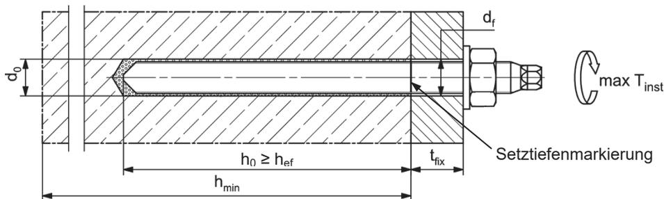
**Gewindestangen, Unterlegscheiben und Sechskantmuttern dürfen ebenfalls verwendet werden, wenn die folgenden Anforderungen erfüllt werden:**
