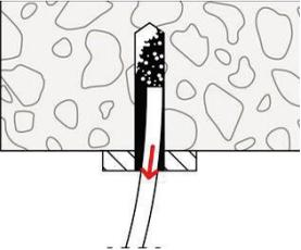
2. Bohrlochreinigung (betrifft nur Hammerbohren).
