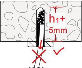
3. Keine Bohrlochreinigung notwendig, sofern Bohrloch 5 mm tiefer gebohrt wird (betrifft Hammerbohren).
