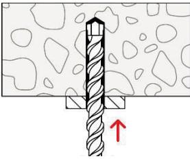
1. Bohrloch erstellen: Hammerbohren oder Hohlbohren.
