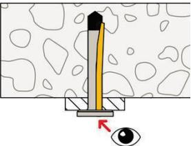
6. Abgeschlossene Montage: Im Falle einer Fehlbohrung: Ein neues Bohrloch muss in einem Mindestabstand der doppelten Tiefe der Fehlbohrung erstellt werden, oder in geringerem Abstand, wenn die Fehlbohrung mit hochfestem Mörtel verfüllt wird und nur, wenn die Fehlbohrung nicht in Richtung der Schräg- oder Querlast liegt.
