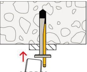
4. Anker setzen: Einbau durch entsprechend geschultes Personal unter Aufsicht des Bauleiters.
