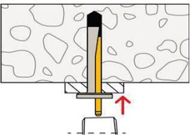
5. Spreizkeil oberflächenbündig eintreiben: Die Bohrlöcher sind so anzuordnen, dass kein Bewehrungstreffer erzielt wird.
