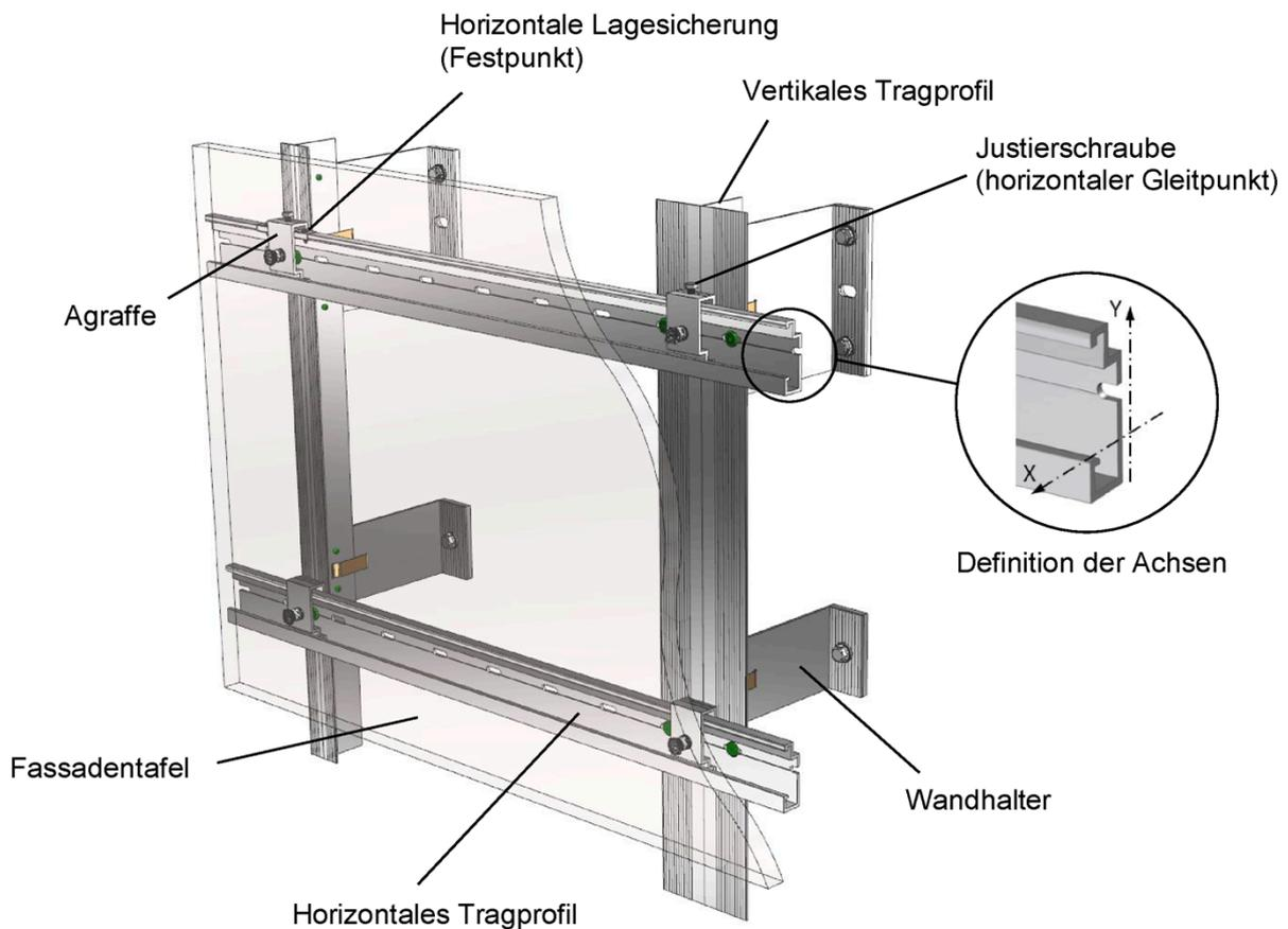
Rückseitige Befestigung von "Eternit Fassadentafel Equitone Tectiva und Linea" mittels Hinterschnittanker "Tergo+"
