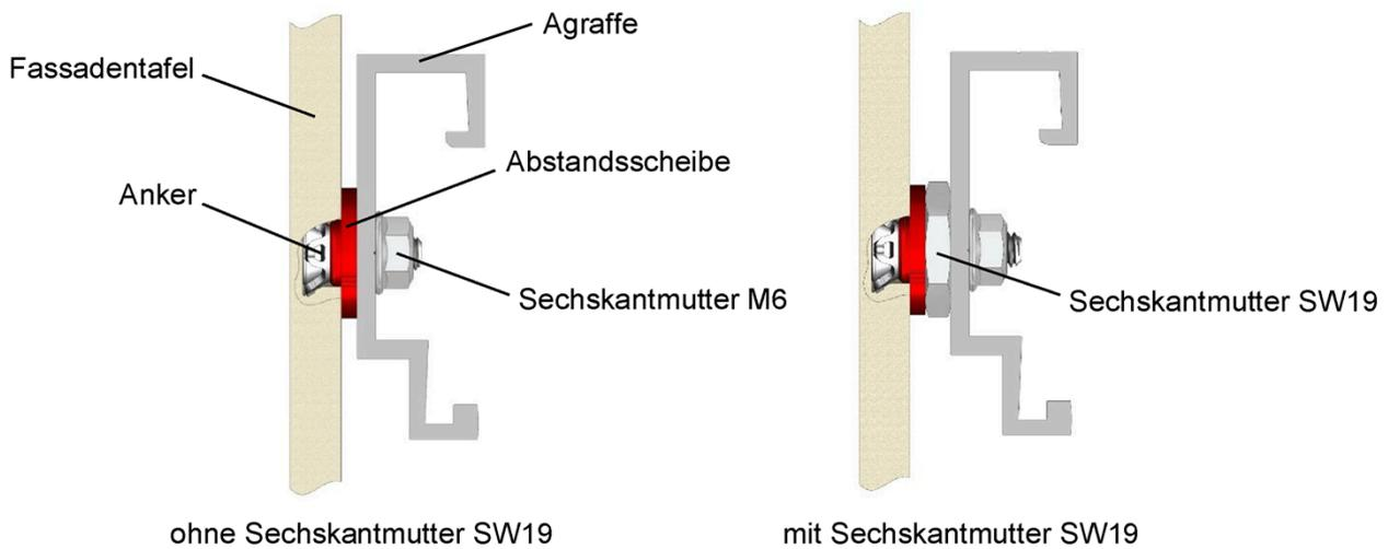
**Beispiel einer Fassadentafel auf einer Unterkonstruktion**
