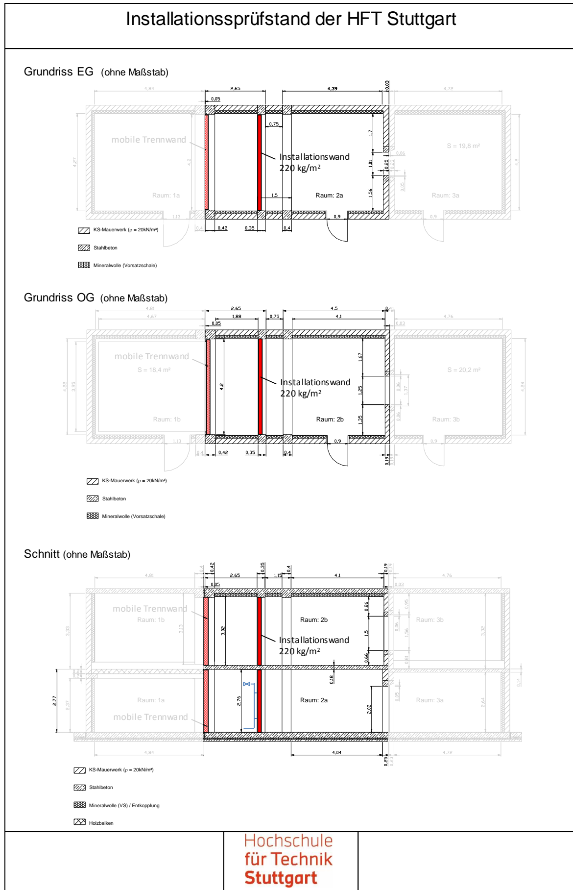
Abbildung 1: Prüfaufbau im Installationsprüfstand der HFT Stuttgart zur Bestimmung der Einfügungsdämmung der Rohrschelle FRS-L
