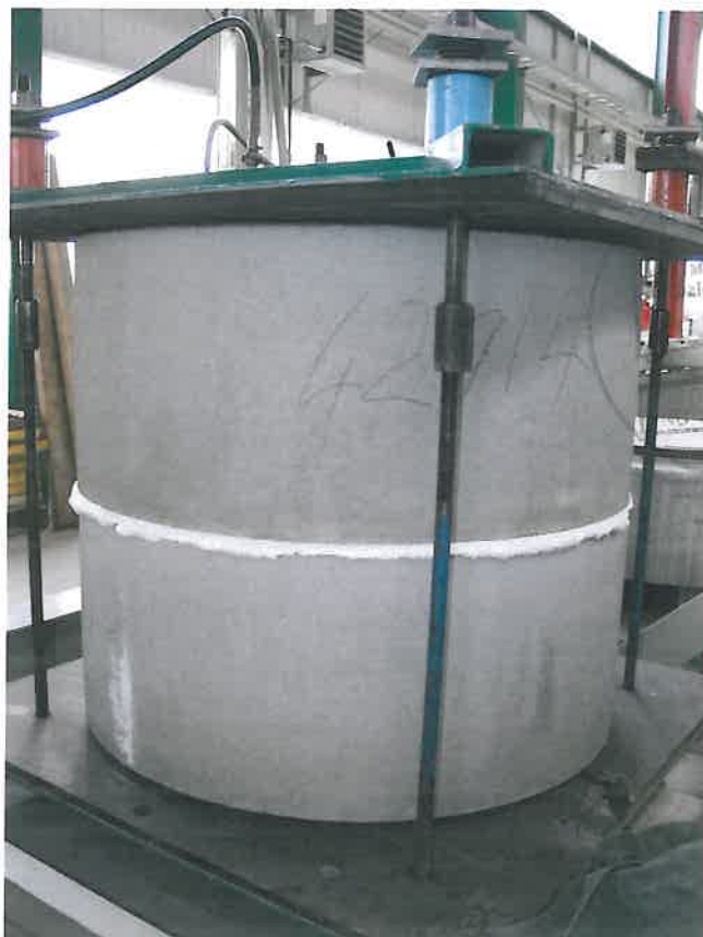
Bilder 3 und 4: Schachtringe gefügt, Verbindung hergestellt, Schaumaustritt an der Außen- und Innenseite
