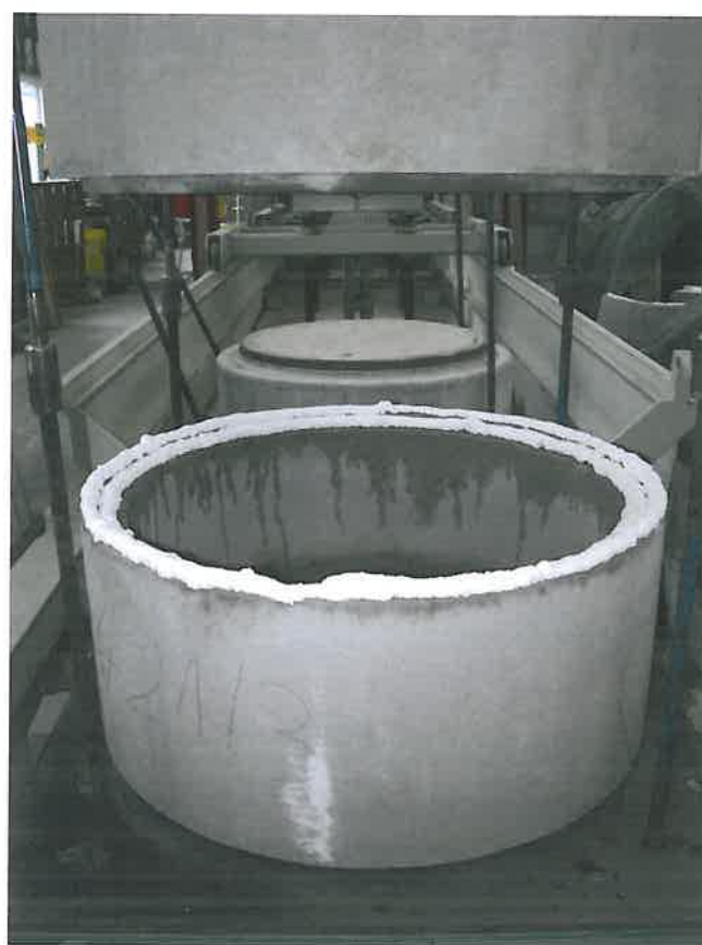
Bild 2: Schaumauftrag in zwei Lagen abgeschlossen
