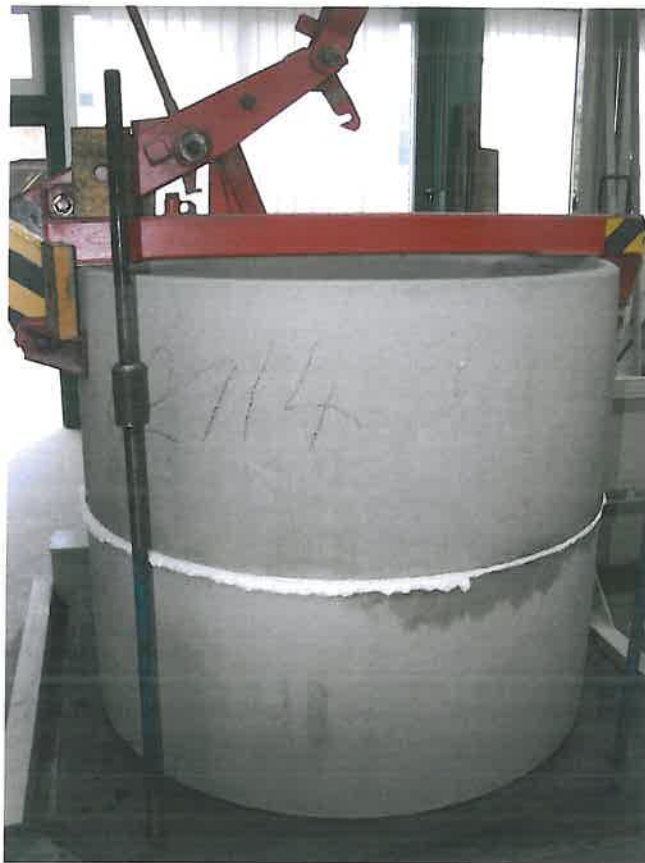
Bilder 3 und 4: Schachtringe gefügt, Verbindung hergestellt, Schaumaustritt an der Außen- und Innenseite
